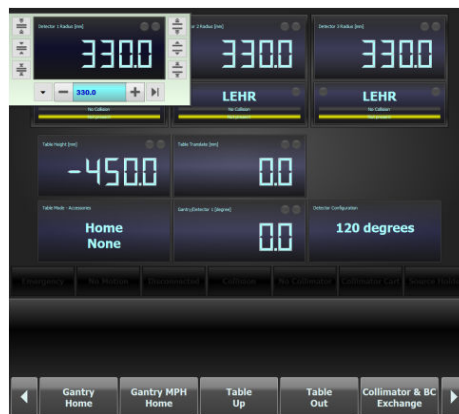
Figura - Cambiar el radio del detector (Pantalla con 3 detectores, aplica a modelo AnyScan TRIO SPECT/CT)
